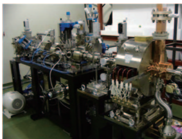
図12. フォトカソードRF電子銃を用いたフェムト秒時間分解・MeV電子線回折装置
