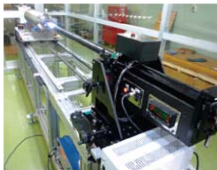
図 7：超伝導空洞の内面を高分解能で検査する内面カメラ装置。これにより、異常温度上昇をしている部分と内表面の欠陥や異常との関連を取る事ができる。
