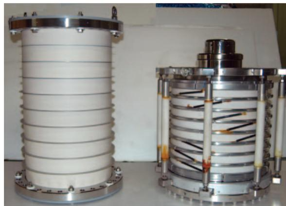
図9：500kV フォトカソード DC 電子銃用に製作した分割セラミック管（左）と、JAEA-FEL で使用した 250kV 熱電子銃の分割セラミック管（右）。500kV セラミック管の大きさは、直径 400mm、高さ 750mm である。
